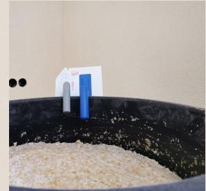
Mischen Sie den Inhalt des Gebindes mit der angegebenen Menge Wasser. Diese Werte sind auf dem Gebinde vermerkt. Bitte achten Sie darauf, dass der Eimer absolut sauber und frei von irgendwelchen Resten ist, um eine optimale Mischung zu gewährleisten.
